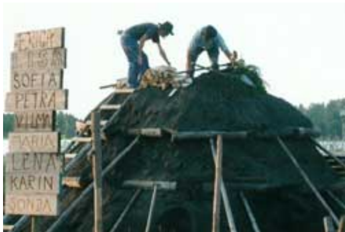
Förberedelser för tändning av Matilda 2003. Tändved läggs upp på kullen. Foto: Anders Janssen.
